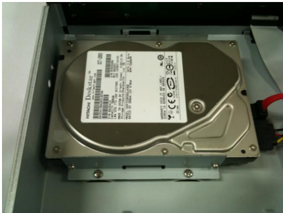
3. 제품 바닥면의 홈과 조립한 하드의 홈을 일치 시킨 후 그림과 같이 조립합니다.
